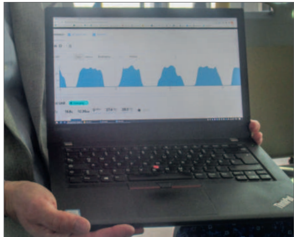
Der Monitor zeigt die Stromaufnahme während der Fahrt. Die Werte sind unabhängig von Wetter und Außentemperatur
